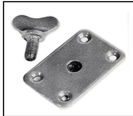
螺紋板是中央鑄有M10 螺絲母的鋼板，通常與M10翼形螺釘一同使用。翼形螺釘也可替代舞台螺釘的功用。螺紋板四角要用8號木螺釘來固定。
